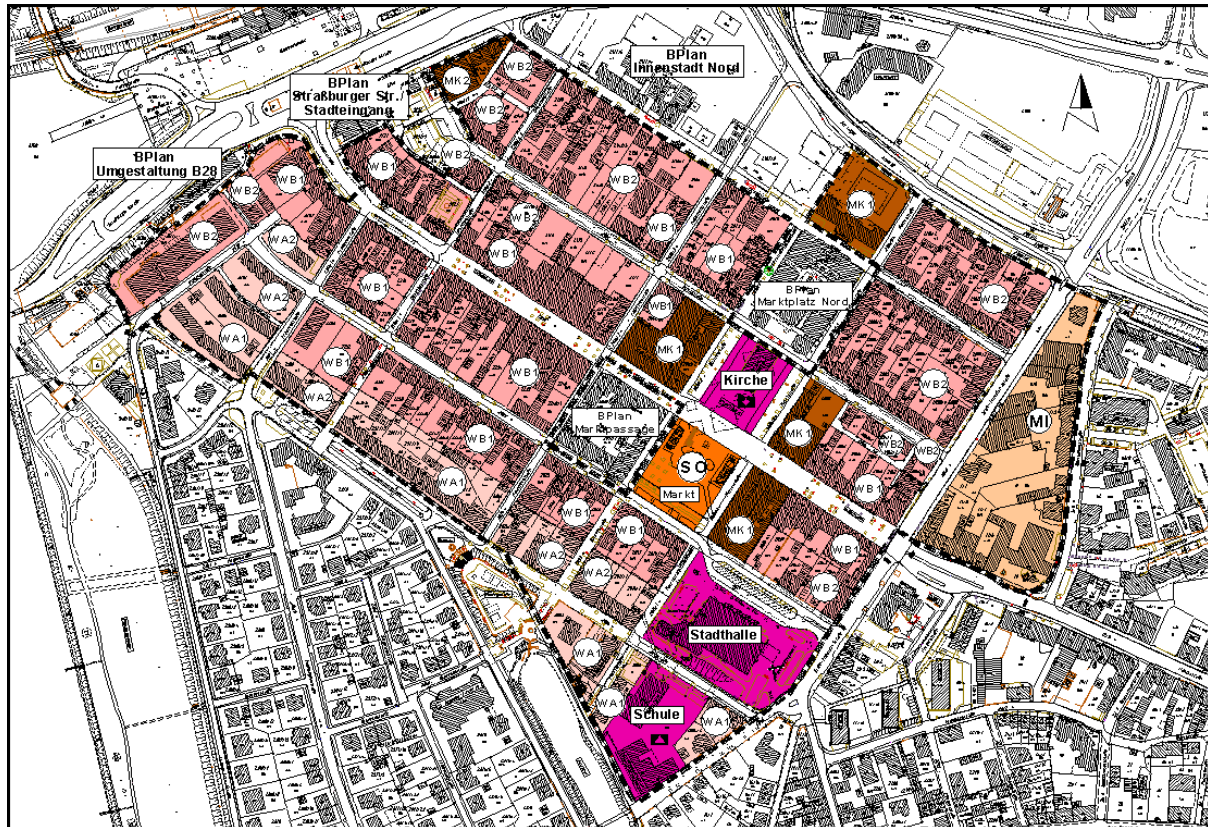
Abb. 5: Bebauungsplan zur Regelung der Art der baulichen Nutzung im Kernstadtbereich in Kehl-Stadt, 1. Änderung
